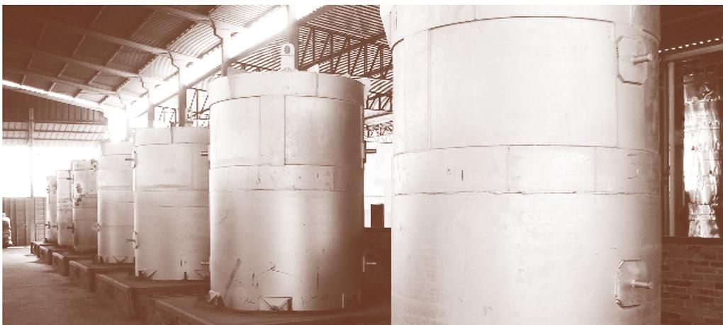
**Figura 6** – Sistema de carbonização e resfriamento do forno Bricarbras
