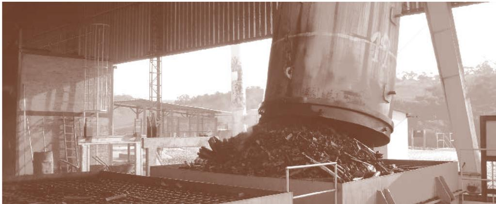
**Figura 7** – Sistema de descarga do carvão vegetal do forno Bricarbras
