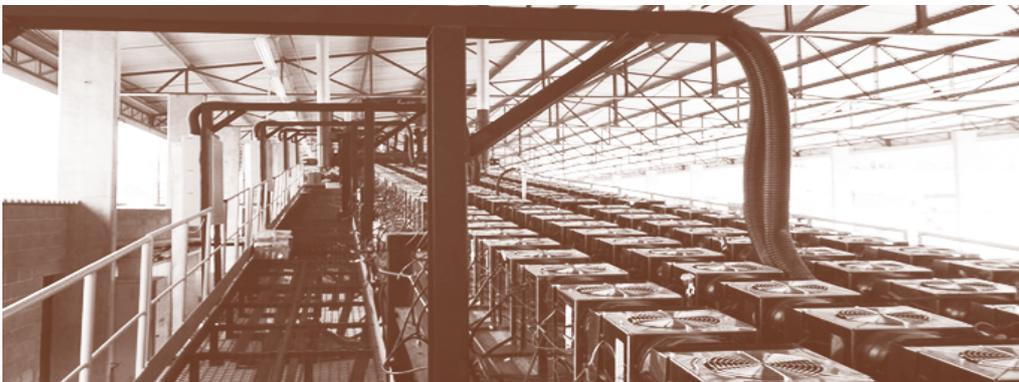
**Figura 11** – Processo de carbonização da madeira via micro-ondas
