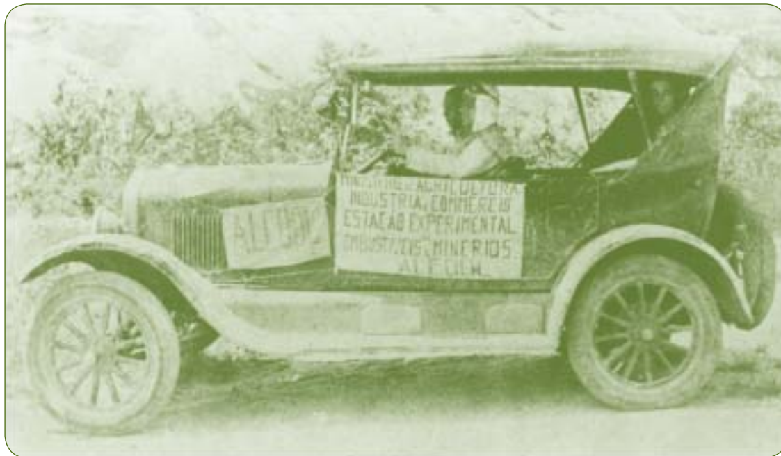
Vehículo Ford adaptado por el INT en el año 1925 para demostraciones del uso de bioetanol puro como combustible.
