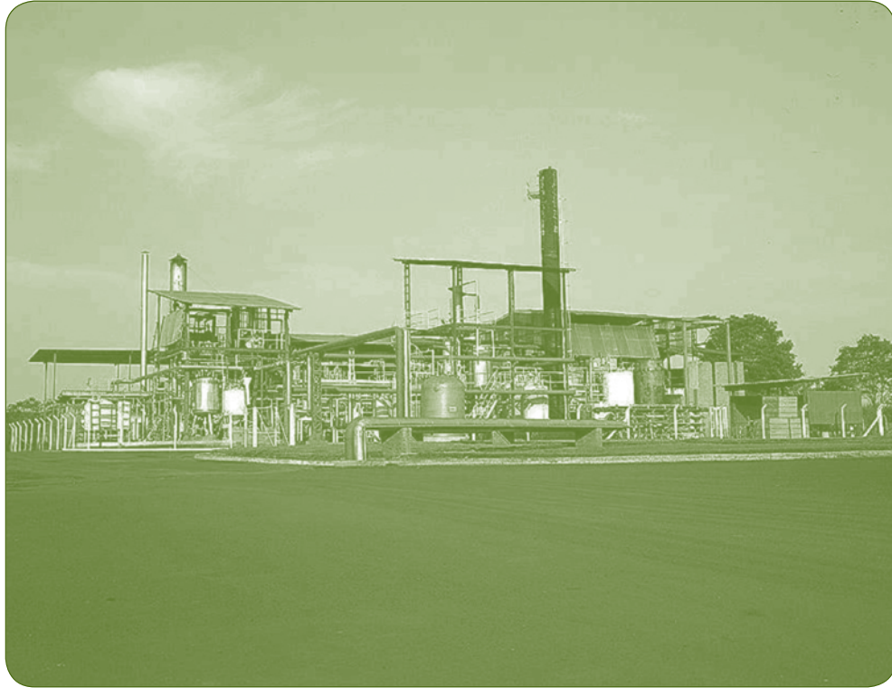
Usine-pilote de PHB Industrial S.A. pour la production de plastique biodégradable à base de sucre de canne.
