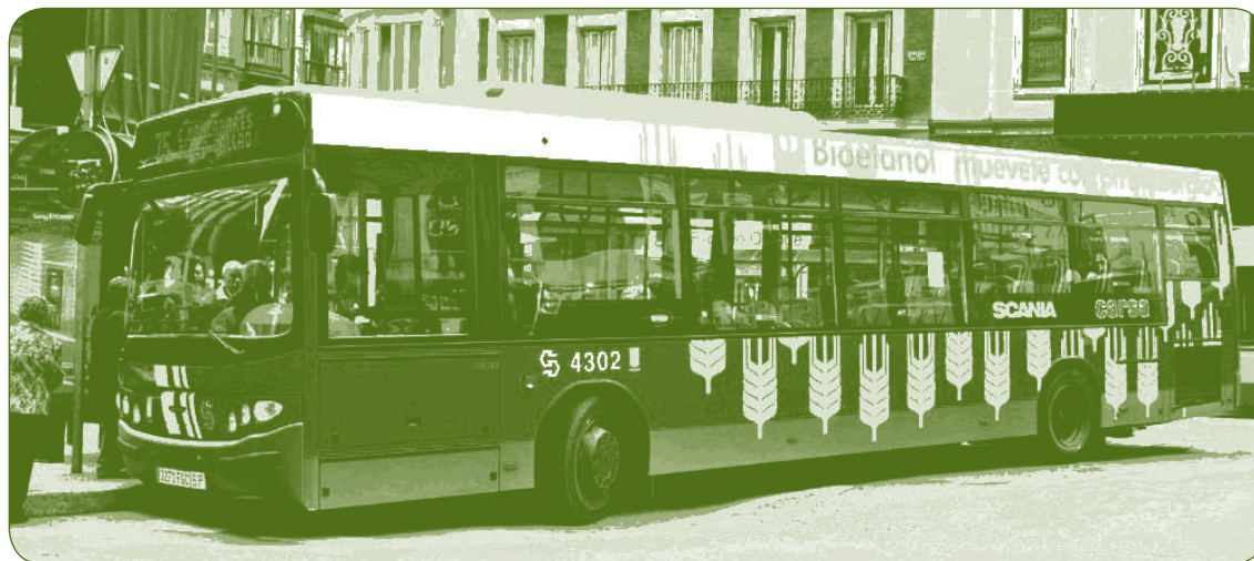
Autobus avec moteur cycle Diesel à l'éthanol hydraté, à Madrid [Sugre (2008)].
