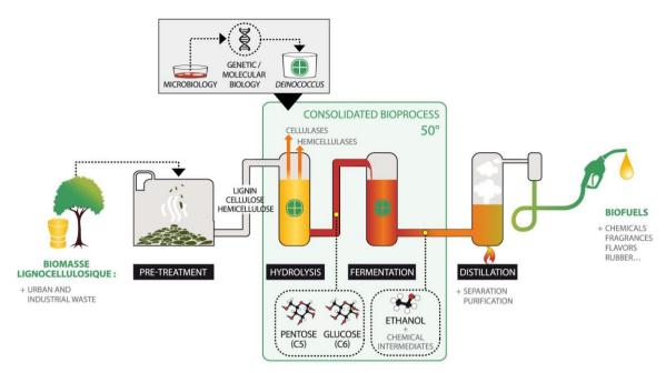
**Figura 15** - Esquema de processo de produção do bioetanol de segunda geração. Fonte: Hasunuma e Kondo, 2012.
