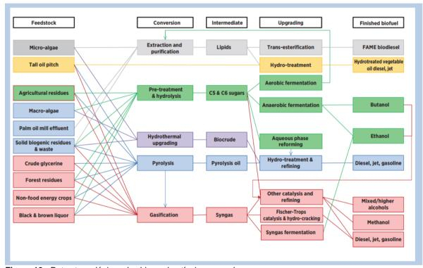
Figura 10 - Rotas tecnológicas dos biocombustíveis avançados
