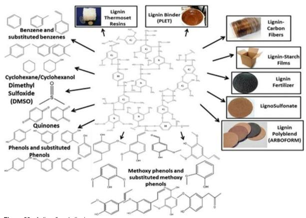
**Figura 20** - Aplicações da lignina Fonte: Tian, Xiaofei et al., 2016.
