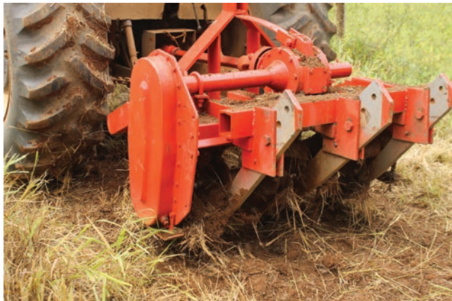
Foto 1. Equipamento utilizados na formação de SAF: enxada rotativa com subsolador
