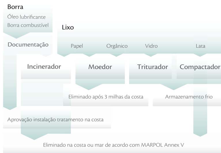
Figura 2-20: Principais resíduos líquidos e sólidos de uma embarcação
