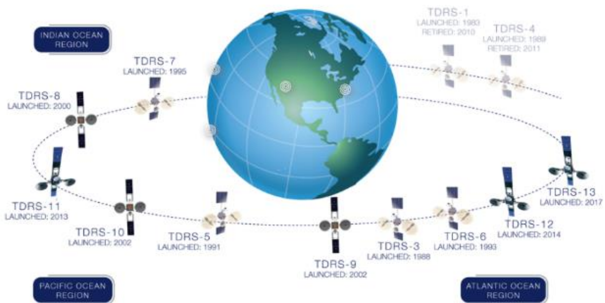
Figura 13 - Ilustração da rede de satélites retransmissores TDRS da NASA.
