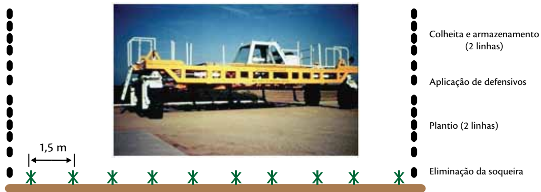
Figura 2-17: Número de passadas de pneus nas entrelinhas de plantio da cana-de-açúcar no esquema de mecanização com estruturas de tráfego controlado (ETC)
