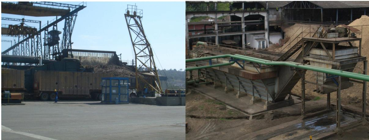
**Figura 5.3-2: Lavagem da cana e sistema de decantação da água utilizada no processo de lavagem**
