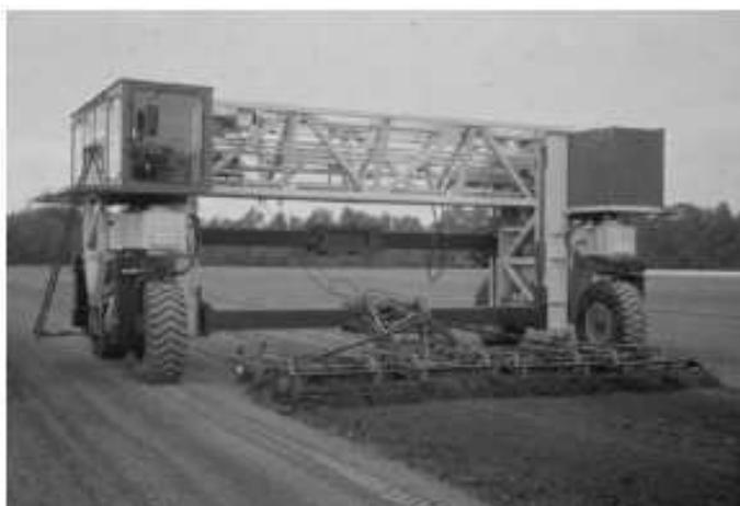
**Figura 4.2.1-13: Veículo de estrutura larga usado para pesquisas de tráfego controlado (fonte Raper & Kirby, 2006)**
