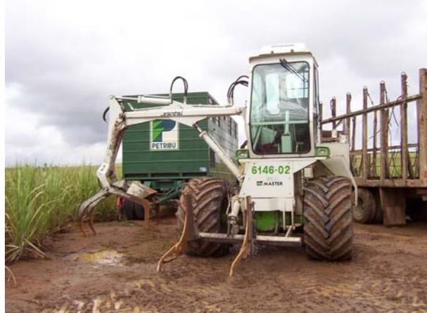
**Figura 3.2.1-8: Vista frontal da carregadora (Santal) utilizando pneus de alta flutuação**
