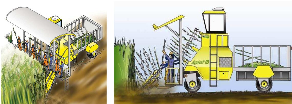
**Figura 4.2.1-18: Auxílio mecânico para a colheita de cana crua em terrenos declivosos - com despalhamento e despontamento (tecnologia em desenvolvimento)**
