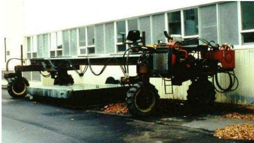
**Figura 4.2.1-12: Veículo experimental "Gantry" (fonte LAGUË; AGNEW & KHELIFI, 2003)**
