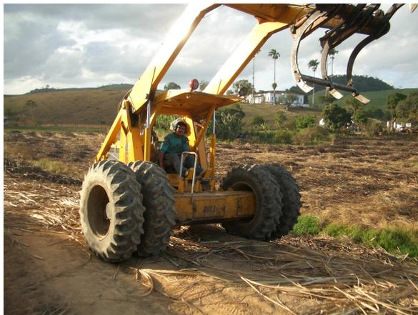
**Figura 4.2.1-1: Carregadora Implanor Bell com bitola larga e centro de gravidade baixo, montada sobre pneus**
