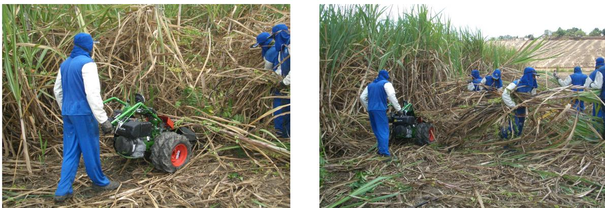
**Figura 4.2.1-19: Auxílio mecânico para a colheita de cana crua em terrenos declivosos, sem despalhamento e despontamento (testes Usina Bom Jesus, PE)**
