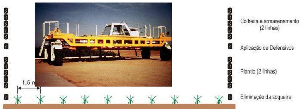
**Figura 4.2.1-14: Número de passadas de pneus nas entrelinhas no esquema de mecanização com estruturas de tráfego controlado (ETC) e Plantio Direto**
