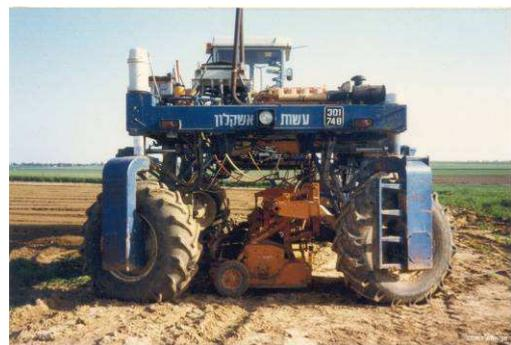
**(b) Posição das rodas que permitem o giro do veículo sobre seu próprio eixo**
