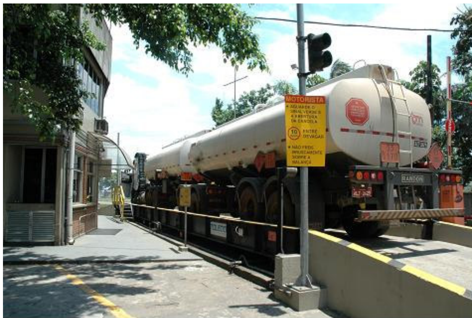
Figura 5.3-29: Posto de pesagem de caminhão tanque.
