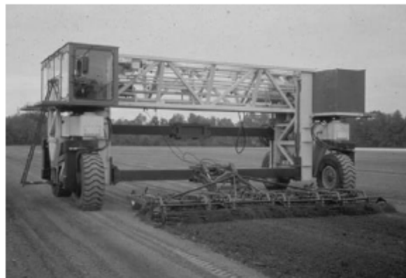
b) Estrutura de tráfego controlado
