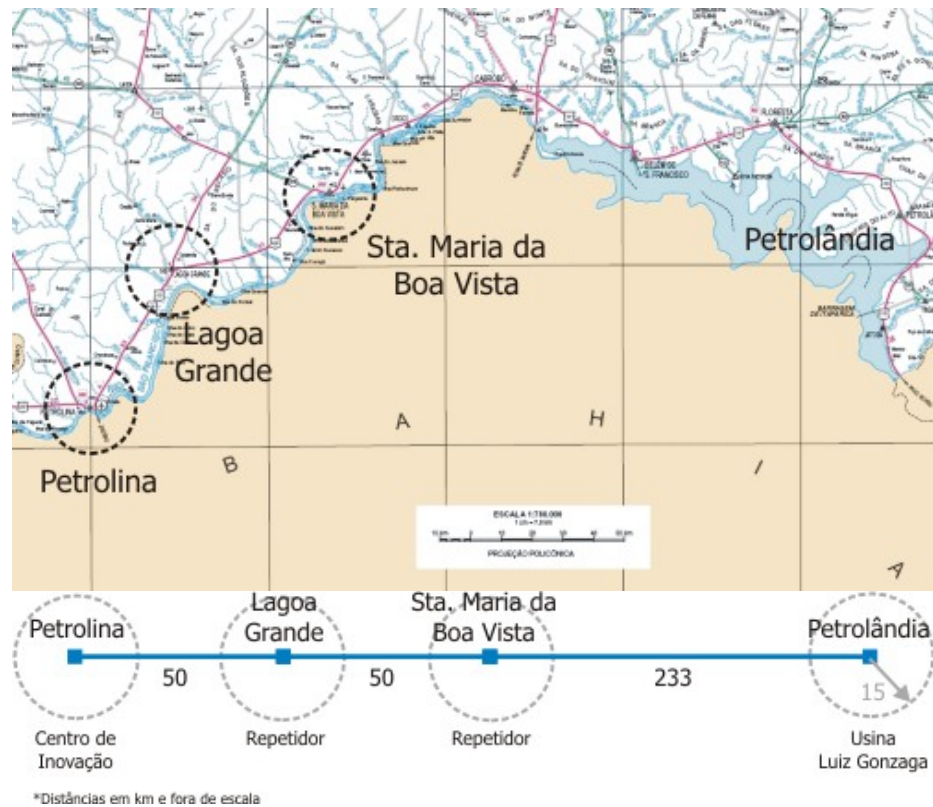
Figura 11: Infra-estrutura de comunicação óptica para o setor de Uva e Vinho
