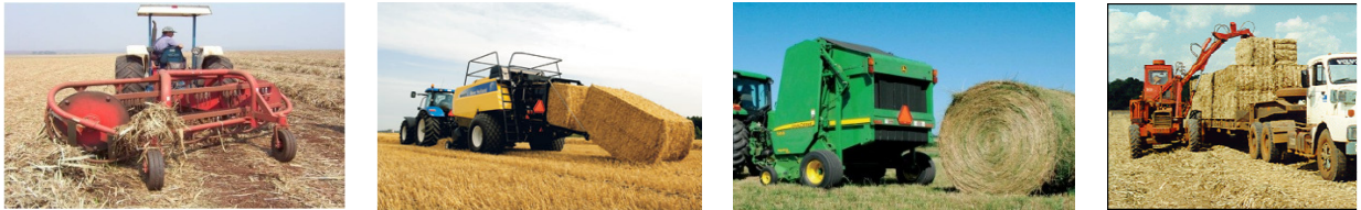
Figura 7 – Sistemas de recuperação de palha de cana (a). Da esquerda para direita, enleiramento, enfardamento e carregamento.
