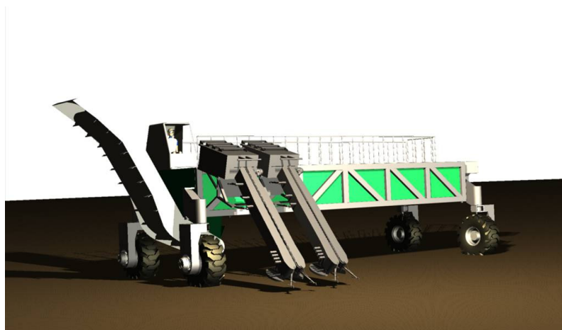
Figura 15: Estrutura de tráfego controlado (ETC) proposta pelo CTBE no programa de Mobilização de Baixo Impacto (MBI) para produção de cana-de-açúcar.
