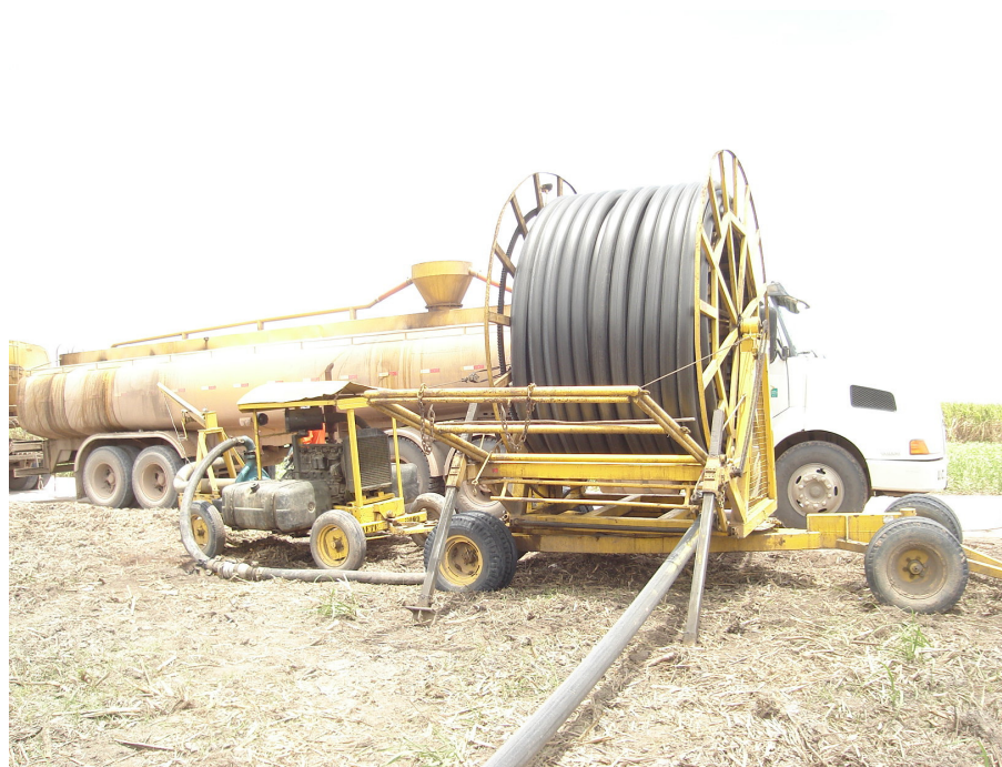
Figura 28. Vinhaça transportada por caminhão e aplicada pelo sistema rolão-canhão aspersor (Foto: Rossetto,R.).
