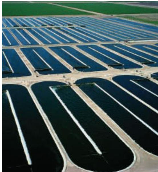
Figura 29. Tanques do tipo "raceway" para crescimento de algas. Foto: http://www.electricitybook.com/algae-biodiesel-2/algae-ponds.jpg
