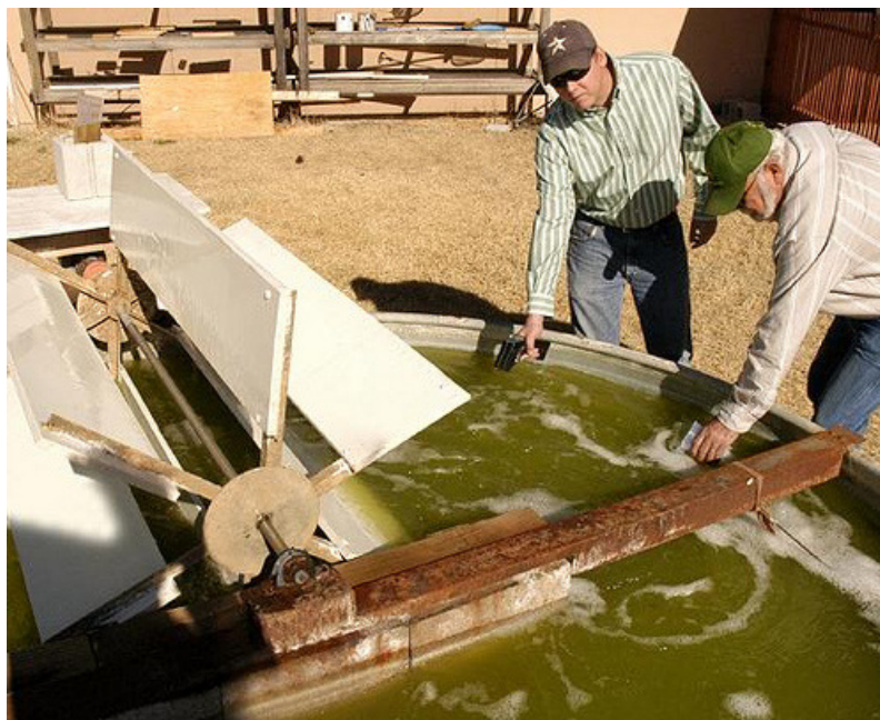
Figura 30. Detalhe do tanque tipo "raceway" mostrando as abas para a aeração. Foto: www.impactlab.com/.../05/algae_biodiesel1.jpg
