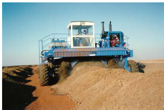
Figura 6: Misturador de resíduos operando na compostagem da torta de filtro
