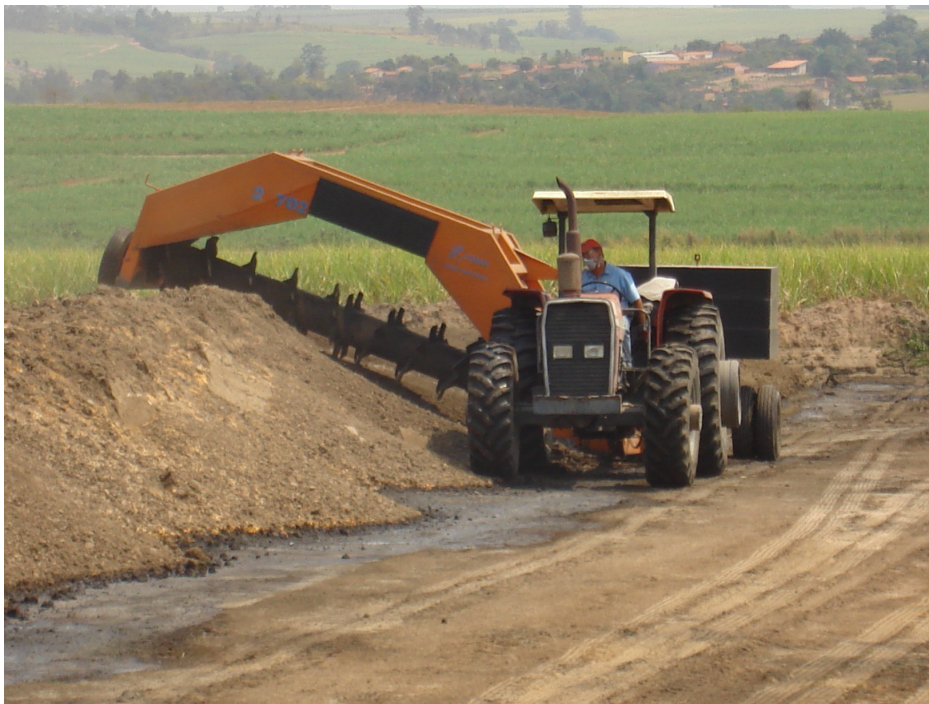
Figura 23. Revolvedor de torta-de-filtro acoplado ao trator para a compostagem. (Foto: Rossetto, R.).
