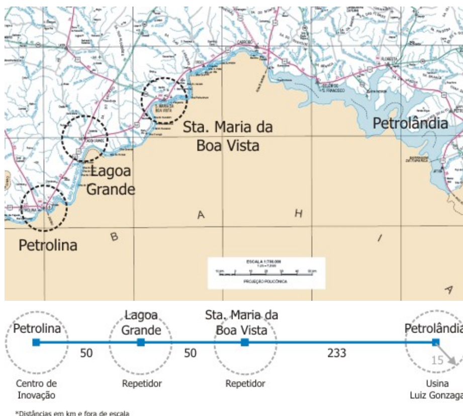
Figura 6: Mapa e diagrama esquemático para implantação de infra-estrutura de comunicação óptica para o setor de Uva e Vinho.
