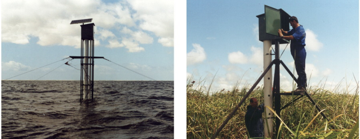
Figura 5.7: Torre estaiada (E) e torre tripé no fundo do banhado do Taim RS (UFRGS_IPH)
