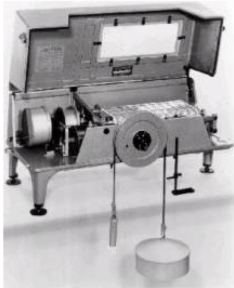
Figura 5.2: Linógrafo de bóia e contrapeso tipo Stevens
