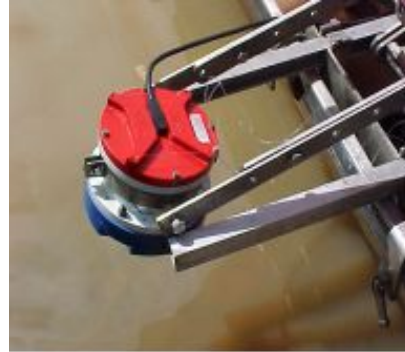
Figura 5.4: ADCP's Broadband de 300kHz (D), para uso em grandes profundidades e Rio Grande de 1200kHz (E), para profundidades menores.
