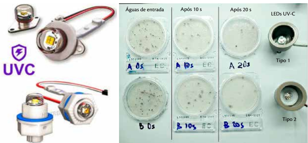
Foto 4. Filtro - Versão 7, com análises de águas submetidas à luz UV-C de LEDs
