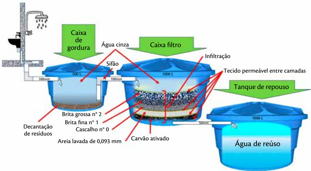
Figura 3. Esquema do Sistema de Filtragem de Água Cinza
