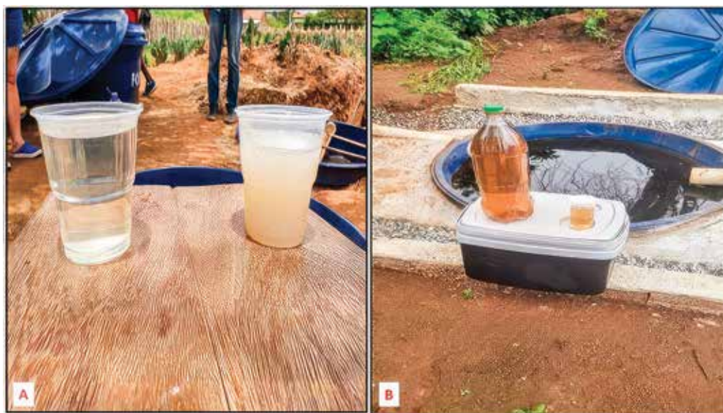
Foto 4. Aspecto dos efluentes coletados após o tratamento nos sistemas de água cinza e fossa biodigestora.
