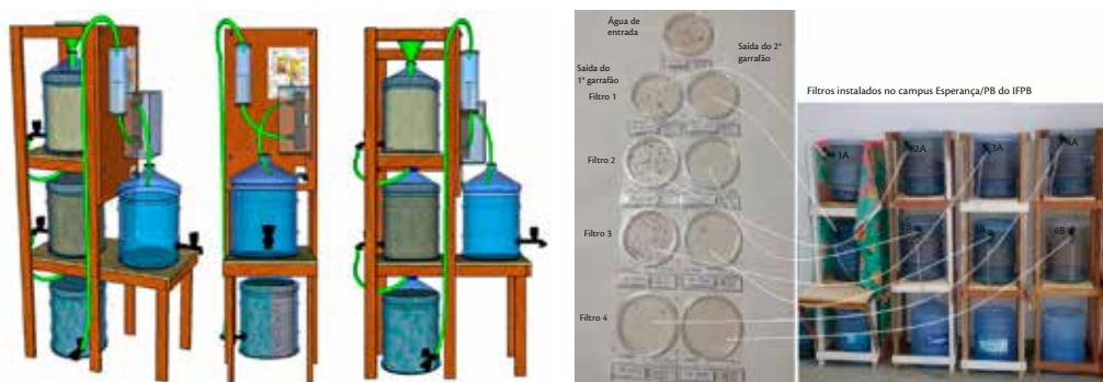
Figura 5. Filtros - Versão 2, instalados e testados no Campus do IFPB de Esperança (PB)
