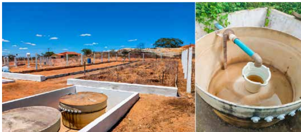
Foto 2. Equipamentos para coleta do escoamento e sedimentos nas parcelas 1 e 2
