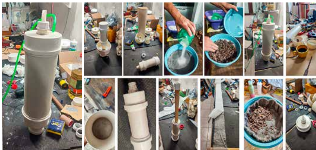
Foto 5. Filtro - Versão 8, com diversos dispositivos para filtração preliminar da água (redução da turbidez) idealizados e testados
